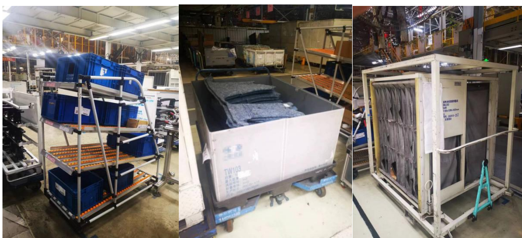
图 10-1 现有零件的三种上线方式
