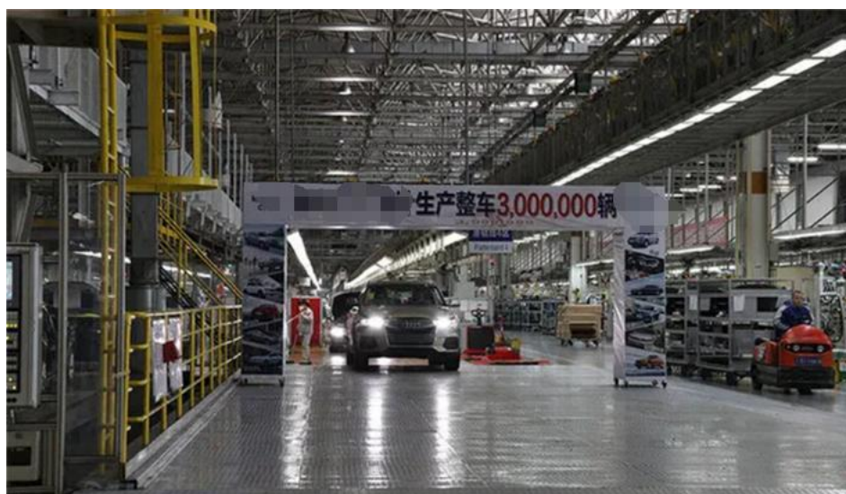
图 10-3 上线牵引车司机配送零件图
